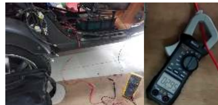
Eksperimen Pengisian Baterai (SMPS bypass ke Baterai Sempat terbaca 2.9A)
